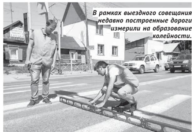
В рамках выездного совещания недавно построенные дороги измерили на образование колеиности.
