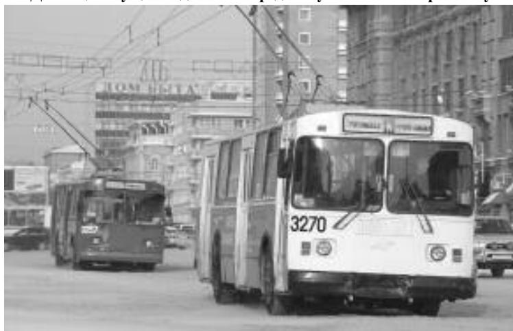
В этом году — впервые за многие годы — Новосибирск закупил 23 новые машины. Конструкция машин разработана с учетом условий сибирской зимы, с применением асинхронного двигателя, монтажа двойного стеклопакета и низкого пола. Уже состоялась передача МКП «ГЭТ» первых троллейбусов, три из которых изготовлены в Энгельсе и два — производства ООО «Сибирский троллейбус» Дзержинскому троллейбусному депо. В ближайшие дни они выйдут на линию.
