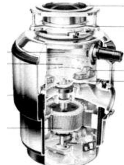
Измельчитель пищевых отходов, иначе называемый диспазером, представляет собой прибор, который устанавливается под кухонную мойку вместо сифона и подключается к системе канализации. По сути, это «моторизованное» мусорное ведро. Прибор состоит из двух основных частей: двигателя и дробильной камеры, где и происходит непосредственно измельчение пищевых отходов. Перемолотые в мелкую кашицу отходы смешиваются с водой и сливаются через выходной патрубок диспазера в канализацию.
