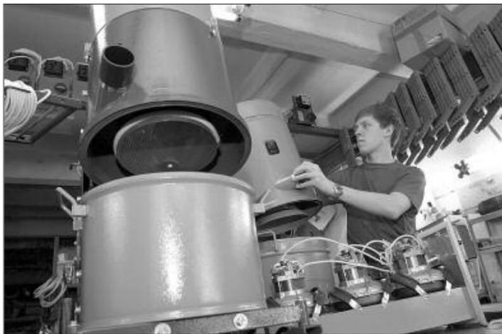
В основе конструкции пылесоса лежит разработанная ранее новосибирскими инженерами уникальная водно-воздушная вихревая камера, способная справляться с большим количеством промышленных загрязнений. Промышленные пылесосы с такой камерой уже много лет успешно справляются с уборкой оборудования и производственных помещений от пыли, песка, битого стекла, опилок, пролитых жидкостей и даже радиоактивной пыли. Однако проблема уборки цементно-бетонной пыли до последнего времени оставалась нерешенной.
