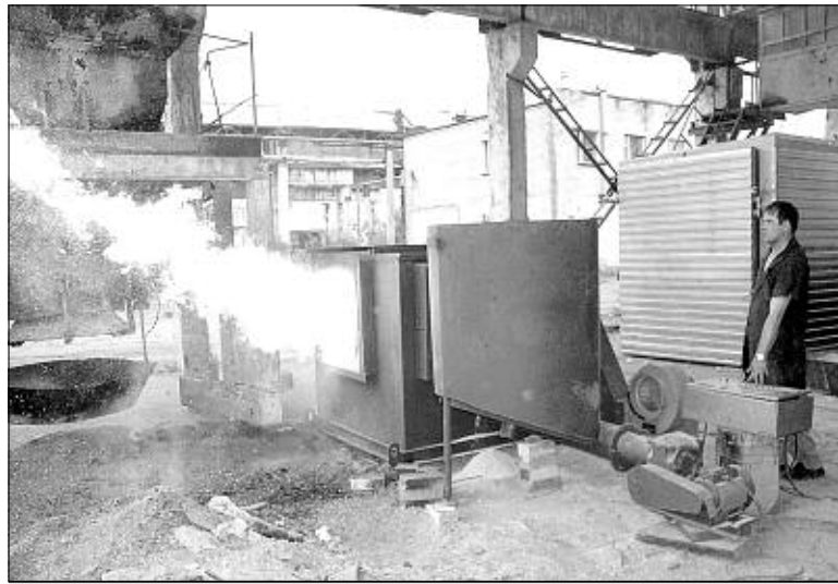
Газогенератор, работающий на древесных отходах.
