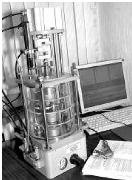
Стабилометр — прибор трехосного сжатия.
