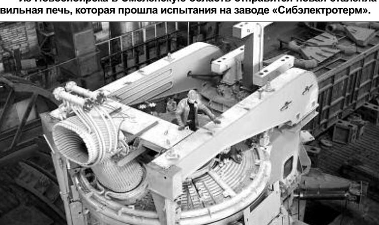
Новая серия дуговой сталеплавильной электропечи — автоматизированное, сверхвысокой мощности оборудование с высокой системой газоочистки — работает в комплексе ковш-печь, что позволяет оперативно доводить выплавку до заданной марки стали и выпускать 220 тысяч тонн жидкого металла в год. Первая такая электропечь будет установлена в городе Ярцево Смоленской области и начнет выпускать сортовой прокат для строительных нужд Москвы и московского региона.
