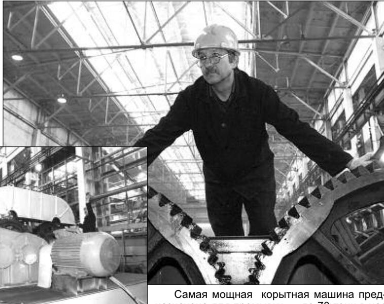
Самая мощная корытная машина предназначена для промывки — до 70 тонн в час — глиннистых руд с различными полезными ископаемыми, а также пород, содержащих алмазы и редкие металлы. Первое отечественное оборудование, разработанное сибирскими конструкторами СКБ горно-обогатительных машин, будет отправлено в Республику Казахстан для переработки марганцевых и хромовых минералов, применяемых в производстве ферросплавов.
