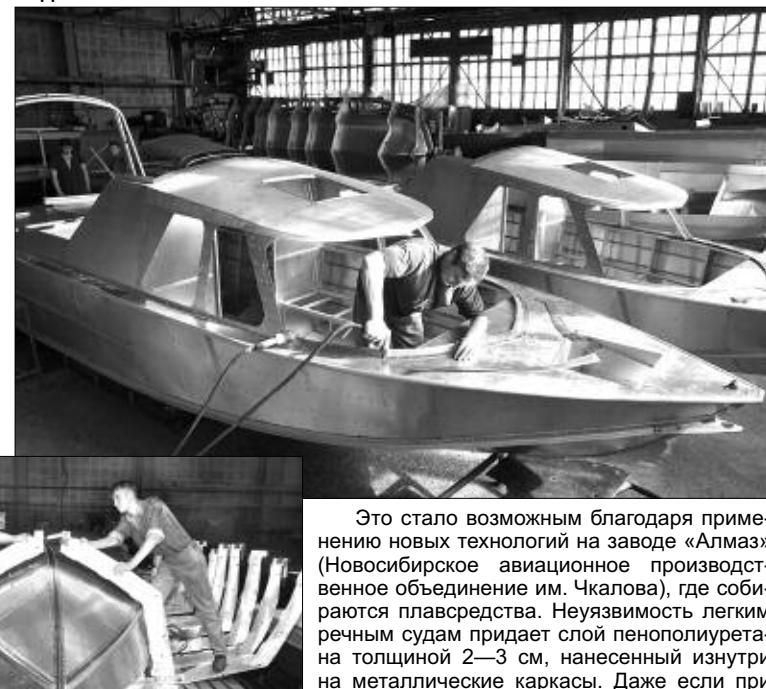
Это стало возможным благодаря применению новых технологий на заводе «Алмаз» (Новосибирское авиационное производственное объединение им. Чкалова), где собираются плавсредства. Неуязвимость легким речным судам придает слой пенополиуретана толщиной 2–3 см, нанесенный изнутри на металлические каркасы. Даже если при аварии они и получат пробоины, то будут держаться на воде и не утонут.
