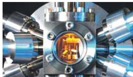
устройство для измерения времени и составить точную карту гравитационного поля Земли. Сейчас разработки новосибирских физиков позволяют достичь погрешности измерений в уровне 10 в минус 16-й степени, однако учёные уверяют, что это не предел – в их силах сделать часы ещё более точными.
