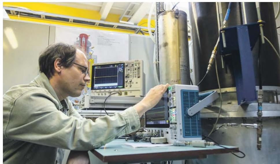
Алексей Левичев у испытательного стенда, справа — изготовленный в институте прототип клистрона.
