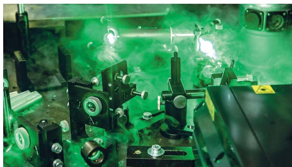
Установка для измерения спектральных характеристик полупроводниковых лазерных структур.
