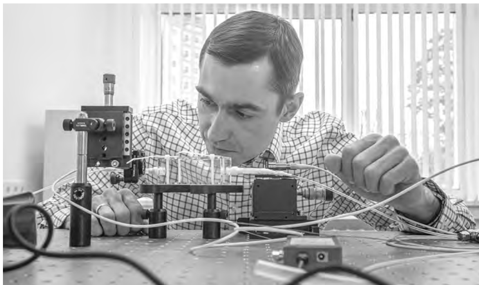
Завлабораторией технологии фотоники и машинного обучения Алексей Редюк с прототипом газового сенсора, который может применяться в шахтах и сельском хозяйстве.
