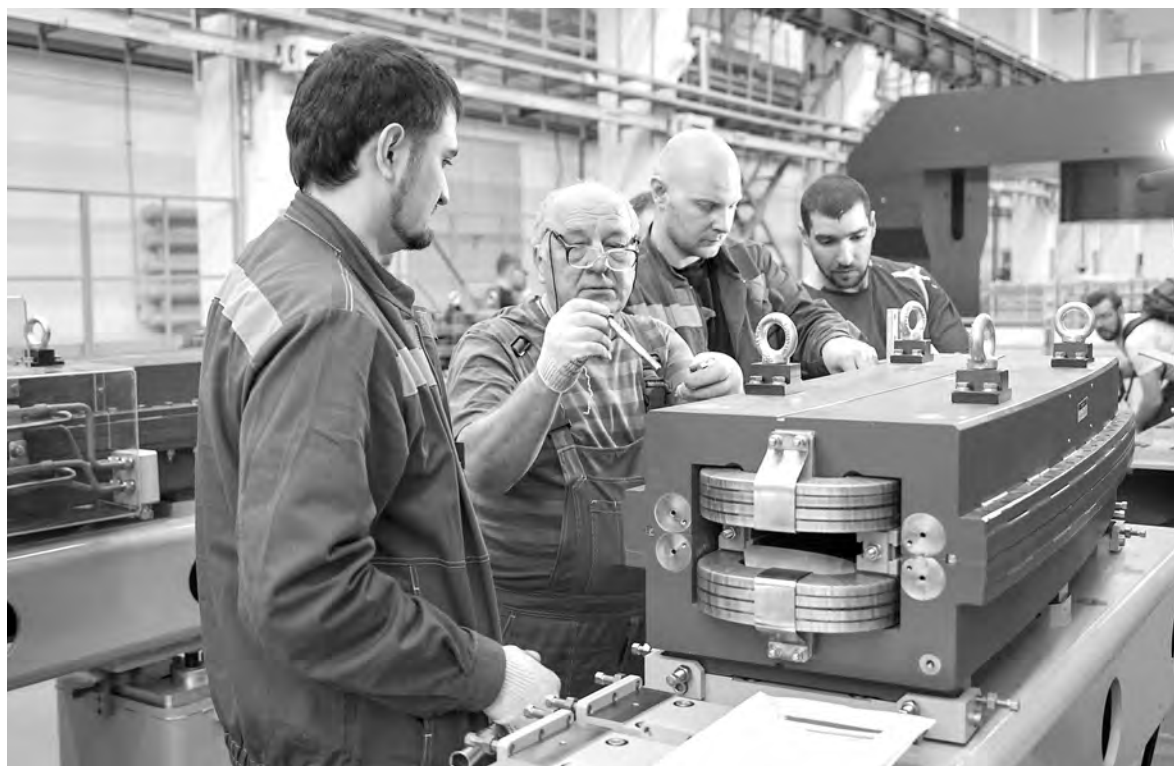
Идёт работа по установке дипольного магнита бустера на прибывшую из Удмуртии подставку-гирдер.
