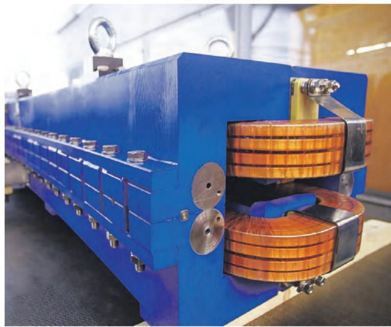
Два магнита для бустерного синхротрона — первые готовые элементы будущего СКИФа.
