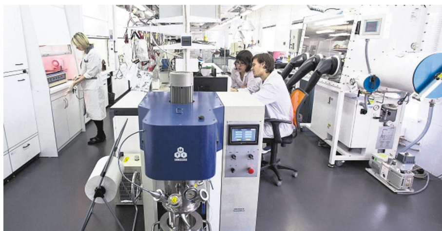
Пилотная промышленная установка синтеза одностенных углеродных нанотрубок установлена в Центре наномодифицированных материалов компании OCSIAI в Технопарке новосибирского Академгородка.
