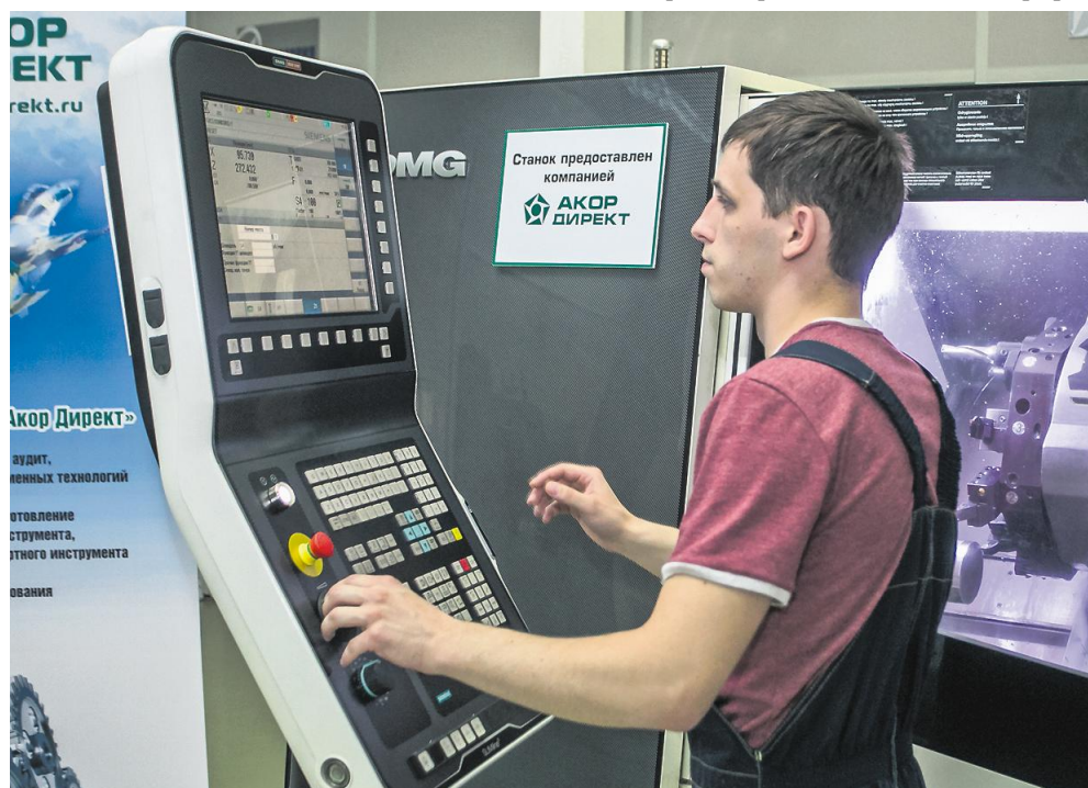
Воронежец Александр Быханов задаёт программу токарному станку с ЧПУ СТХ310eco, предоставленному партнёром лицея фирмой «Акор Директ» (Новосибирск).
