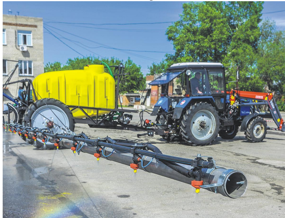
Новосибирский «Агронавигатор» стоит в два раза дешевле импортных и позволяет работать ночью, что повышает производительность работы в десятки раз. На фото — система для обработки полей раствором пестицидов с высокой точностью дозирования.
