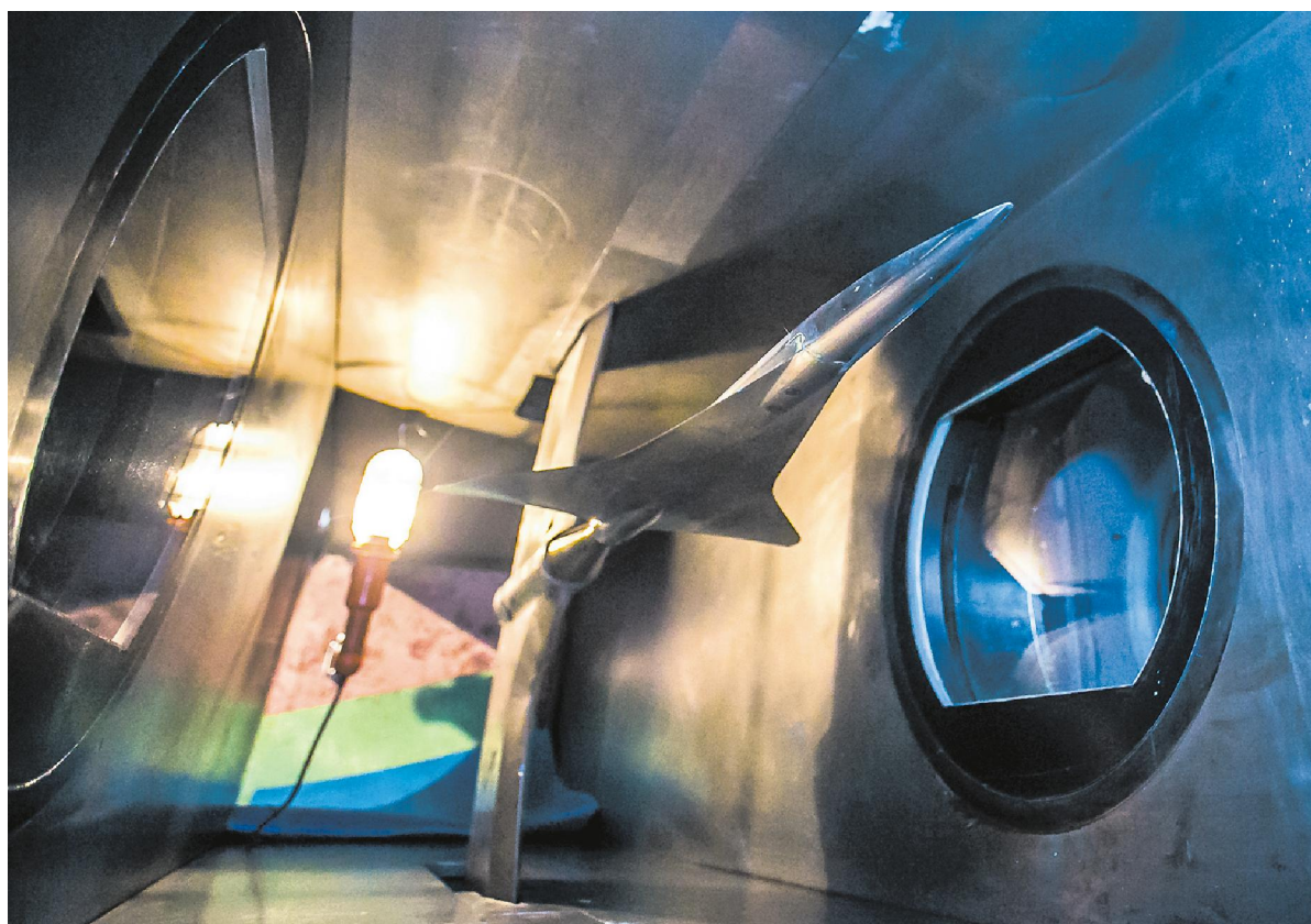
Так выглядит изнутри сверхзвуковая аэродинамическая труба, в которой испытываются модели летательных аппаратов.
