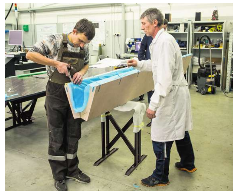
Крылья для нового ЛМС — лёгкого многоцелевого самолёта — изготавливаются из углепластика в специальных формах.
