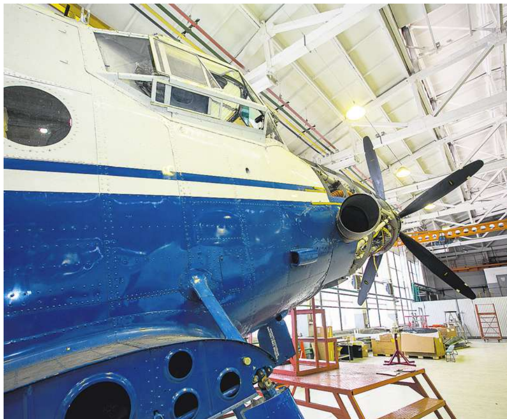
У обновлённого Ан-2 вытянутый «нос» и американский двигатель.
