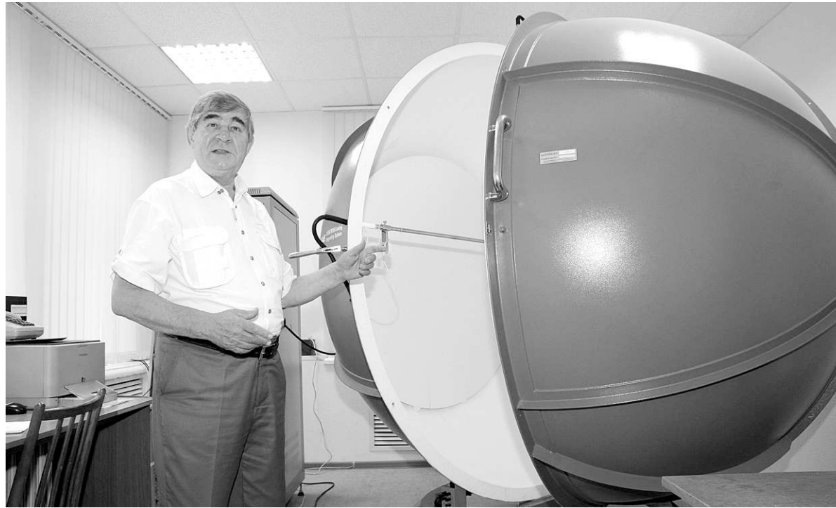
Показатели любого осветительного прибора можно определить в интегральной фотометрической лаборатории.
